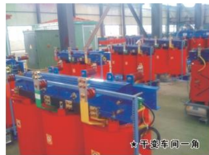
★浇注成型后的干变高压线圈
