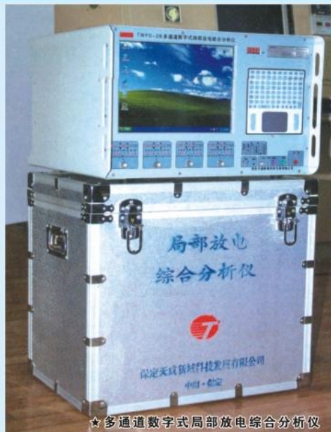
★多通道数字式局部放电综合分析仪
